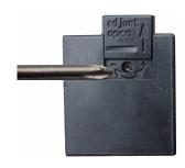
图 11 流量设定值调节示意图
